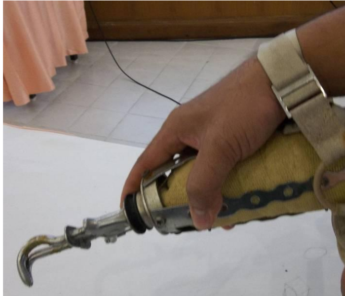
รูปที่ 13 ผู้ประกวดใช้มือของตนเอง สาธิตการใช้งาน โดยใช้สายรัดข้อมือกับมือกลแขนกล
